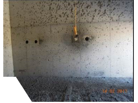
Kapalı Alan Patlayıcı Karakterizasyon Test Düzeneği
